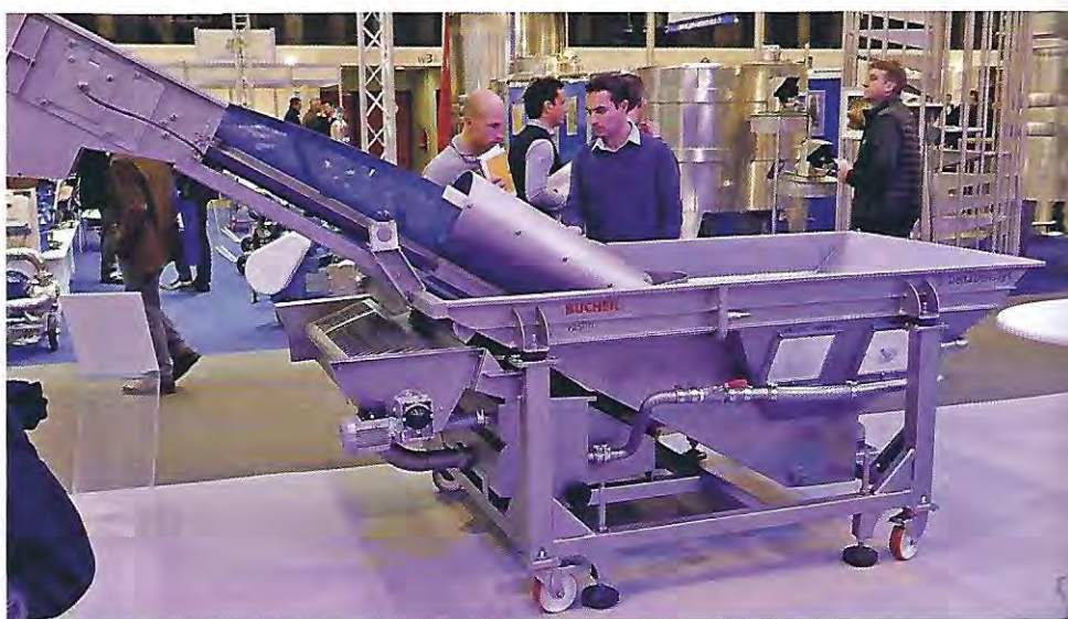
Delta Densilys – Traubenwascher und Selektionseinheit in einem Gerät.
