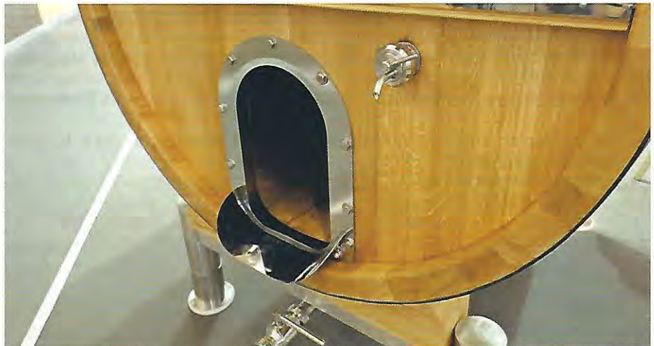
Hygienischer Probehahn der Firma Robinet à Canule, D-Innovation. Es handelt sich dabei um ein Verkostungsventil, dessen Rohr abnehmbar und auswaschbar ist.
